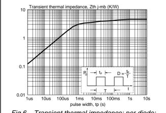
Fig.6. Transient thermal impedance; per diode;  $Z_{th\ j-mb} = f(t_p).$
