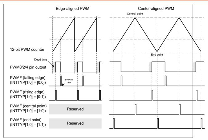
Figure 17-7. PWM Interrupt Type
