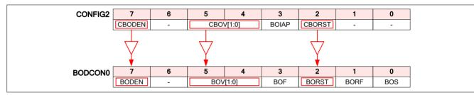
Figure 28-2. CONFIG2 Power-On Reset Reloading
