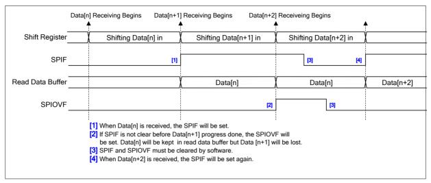
Figure 14-7. SPI Overrun Waveform
