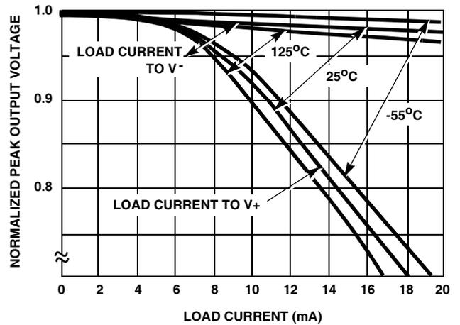
FIGURE 16. TRIANGLE WAVE OUTPUT VOLTAGE vs LOAD CURRENT
