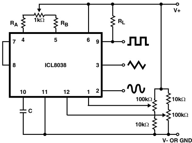
FIGURE 4. CONNECTION TO ACHIEVE MINIMUM SINE WAVE DISTORTION
