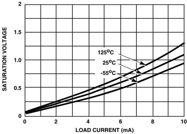
FIGURE 15. SQUARE WAVE SATURATION VOLTAGE vs LOAD CURRENT
