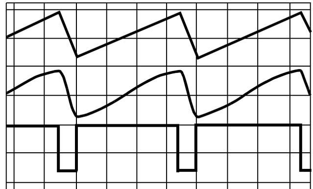
FIGURE 2B. SQUARE WAVE DUTY CYCLE - 80%
