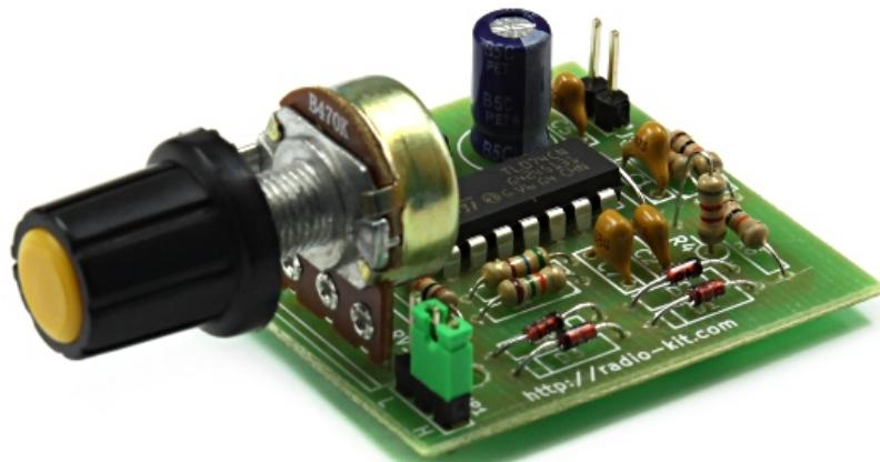
Даний пристрій є простим аналоговим генератором спеціальних сигналів: прямоугольного, трикутного і синусоїдального. Буде корисно для тестування радіоапаратури та всіх, хто вивчає радіоелектроніку.
