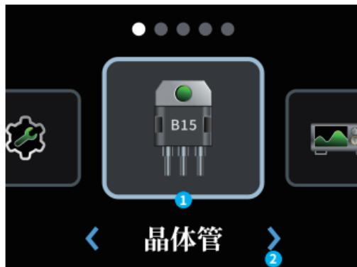
①功能名称:此区域显示此刻选择的功能名称,共5个板块:晶体管、示波器、信号发生器、工具箱、设置。
