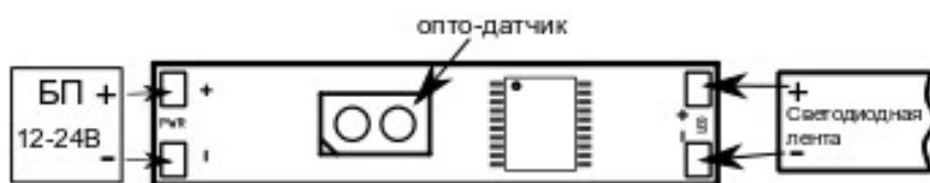
M314.2 встановлюються в торець профілю. З одного боку датчика знаходиться оптичний сенсор, з протилежного - контакти для підключення джерела живлення і світлодіодним стрічкою або лінійки.
